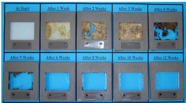
圖 4 · 工業堆肥環境下生物可分解塑膠裂解情形 (從塑膠原本狀態經過 12 週的變化)。來源：宏力生化科技。
